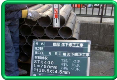
材料の検収(鋼管) 材質:STK400 長さ=750mm 径139.8×厚さ4.5mm
