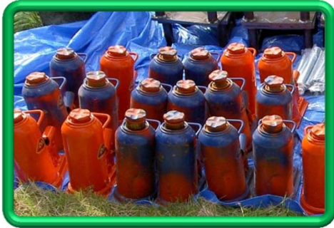
材料の検収 ジャッキ
